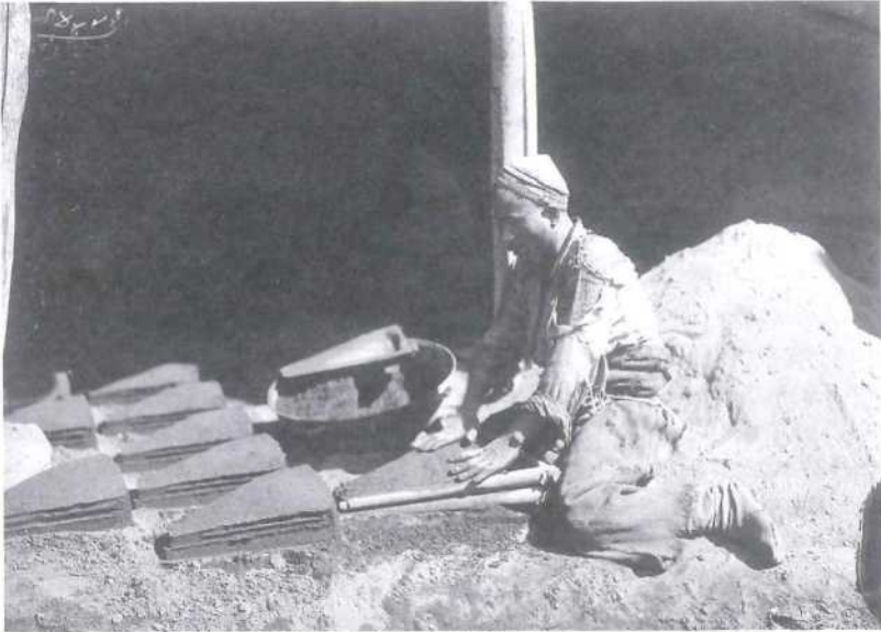
Чугунолитейный завод. Приготовление форм. Самарканд. 1900-1902. РЭМ кол. 48-101
