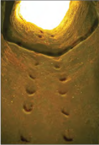
Рис. П.5.3. Так выглядят с глубины подземных выработок хорошо сохранившиеся вертикальные стволы разведывательных и извозных шахт на Каргалах
